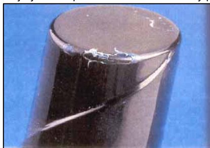
Obr. 6: Odlupování povrchové vrstvy
