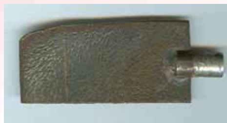
Obr. 2.4. Ukázka erozivně opotřebované lopatky
