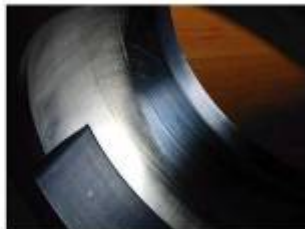
Obr. Vnitřní a vnější kroužek ložiska PLC 89-8 po provozu 10 000 hod. v uložení převodovky na rotační peci
