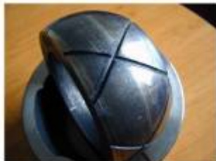
Obr. Vnitřní a vnější kroužek ložiska PLC 89-8 po provozu 10 000 hod. v uložení převodovky na rotační peci
