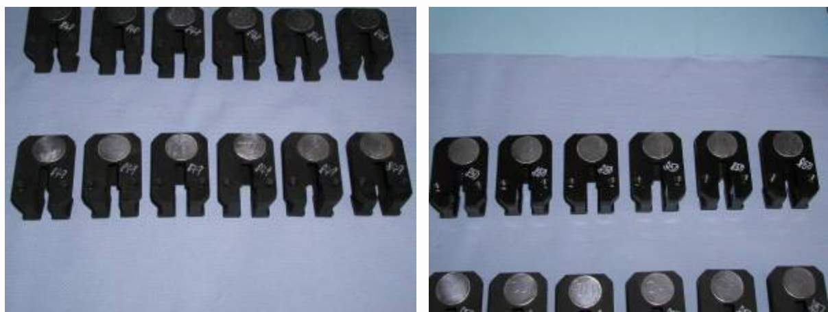
Obrázek 2 – povrchová úprava dílu – černý a lesklý povrch:
