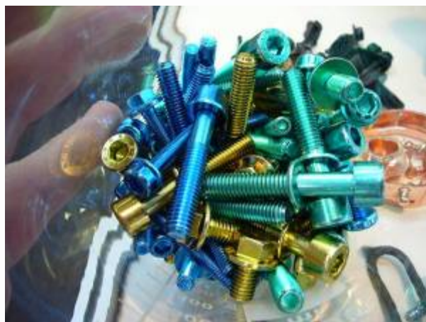
Obrázek 1 – ukázka dílu povrchově upraveného organickým povlakem (KTL - vlevo) a kovovým povlakem (spojovací součástky - vpravo)
