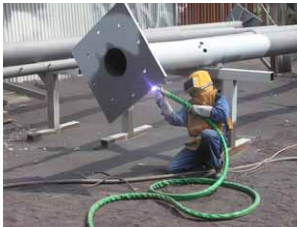
Obr.4: Elektrometalizace nástřik slitinou ZnAl 85/15 v praxi
