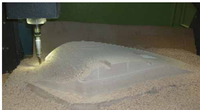
OBR. 2 Model vyráběný CNC obráběním
