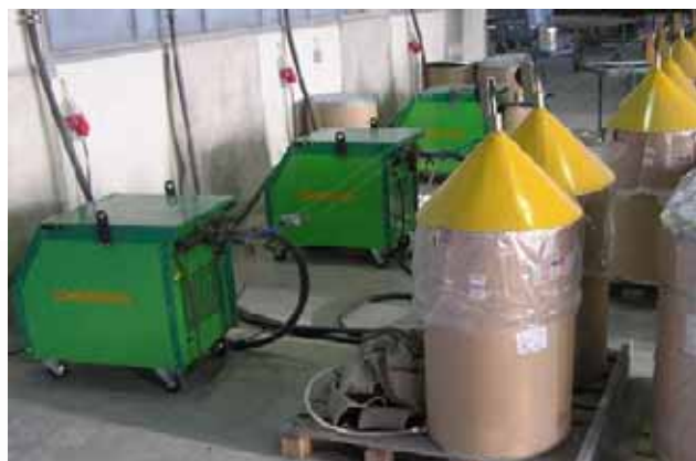
Obr.3: Elektrometalizační zařízení Margarido M45 včetně odvíjení metalizačních drátů
