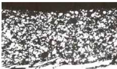
Obr. č. 6: Nátěr EP, vysoký obsah Zn
