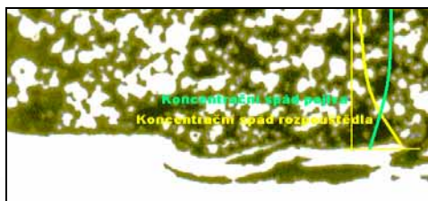
Obr. č. 11: Odpařování rozpouštědel z nátěru
