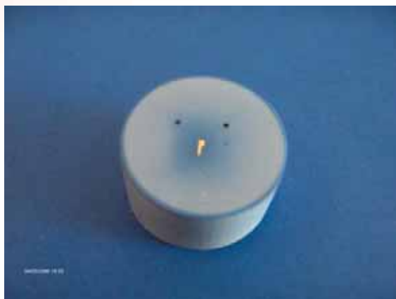
Obr. 5: Vzorek s povlakem NiP-diamant + Ni a jeho metalografický výbrus. Zvětšeno 500 x (obr. vpravo)
