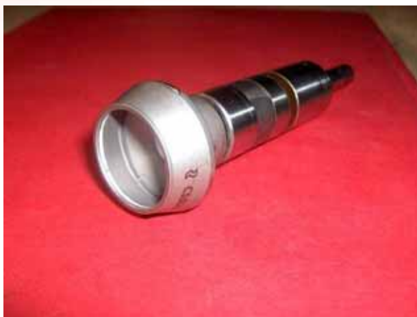
Obr. 1: Rotor spřádacího textilního stroje s povrchovou úpravou NiP-diamant. Tloušťka povlaku 25 \pm 5 \mu\text{m} .
