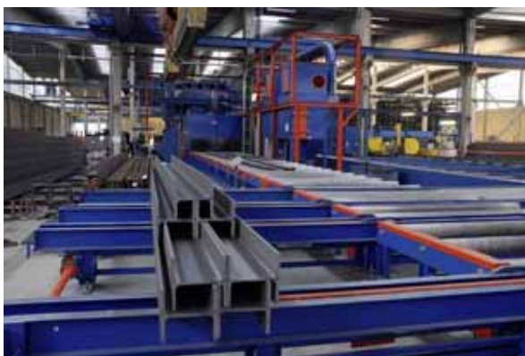
Priečne dopravníky na výstupe z otryskávacieho zariadenia umožňujú jednoduché nakladanie a viazanie otryskaných dielov s oceľovými páskami.
