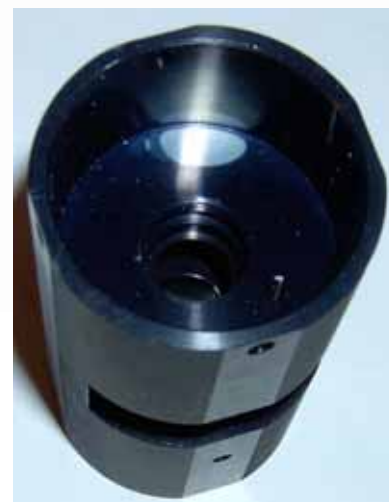
BUBLINA - Nesprávné uchycení součásti v lázni, které má za následek zachycení bubliny stoupajícího kyslíku a vznik
