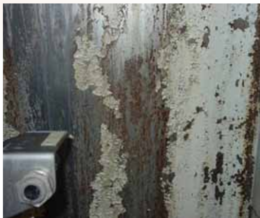
Obrázek 1 – Příklady rozrušování nátěrů obráběcích strojů
