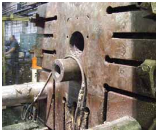
Obrázek 6 – Příklad korozního napadení
