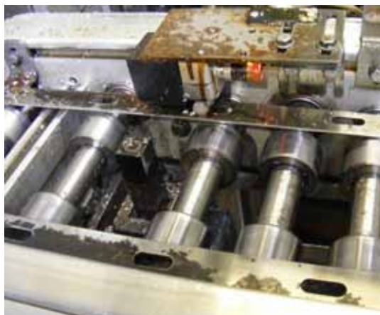
Obrázek 8 – Kontaminace dopravní trati na obráběcí lince a vnějšího povrchu ložiska
