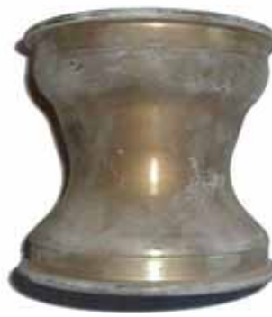
Nesprávná aplikace chromátování (výskyt bílé koroze)
