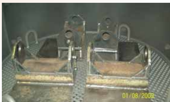
Obr. č. 2.: pohled na tryskané díly ze zkoušek
