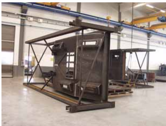
Obr. 2. Opracovávají se trojdimenzionální svařované konstrukce a také díly skříní o hmotnosti 15 tun.
