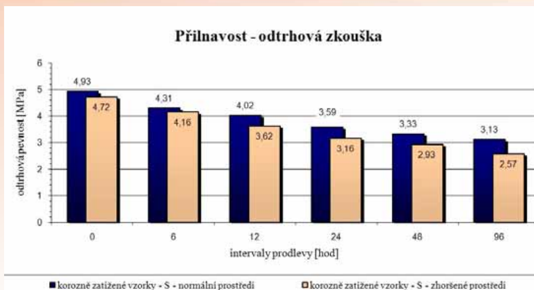
Obr.9 Porovnání závislosti odtrhové pevnosti vzorků z normálního a ze zhoršeného prostředí zatížených korozní zkouškou – S – na době prodlevy aplikace nátěru po tryskání
