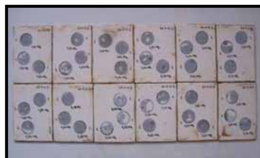
Obr. 3 Mřížkový řez na korozně zatíženém vzorku K1-1-2-R
