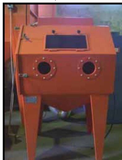
Obr. 2 Injektorová tryskací kabina VALET 25+
