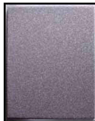
Obr. 1 Vzhled povrchu vzorku po tryskání korundem zrnitosti F16, tlak vzduchu 0,6 MPa, doba tryskání 2 min.
