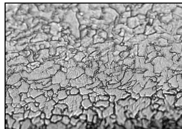
Obrázek 16: Vzhled mikrostruktury oceli 4 ve stavu po žárovém zinkování
