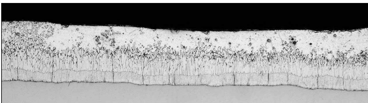
Obrázek 10: Vzhled mikrostruktury povlaku na oceli S355MC (doba ponoru 7:30 min)
