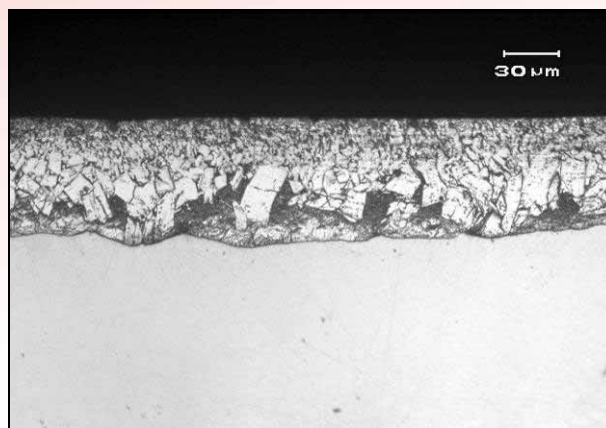
Obr. 4f: Mikrostruktura povlaku u vzorku 4–50
