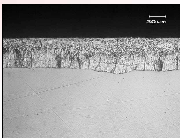
Obr. 2b: Mikrostruktura povlaku u vzorku 1–10
