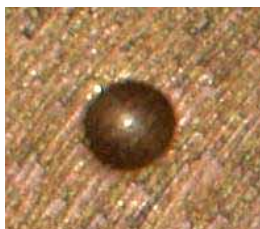
Obr.4: Vtisk po Brinellově zkouřce [6] metody
