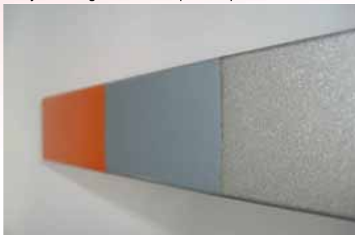
Obr. 1. Práškový epoxidový základní povlak s obsahem zinku na otryskaném ocelovém profilu
