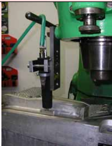
Obr. 4.1 Princip testování otěruvzdornosti
