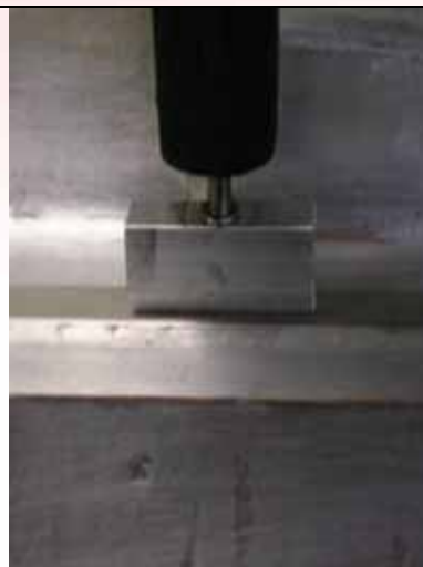
Obr. 4.2 Kladívko vytvářející opotřebení dělicí roviny
