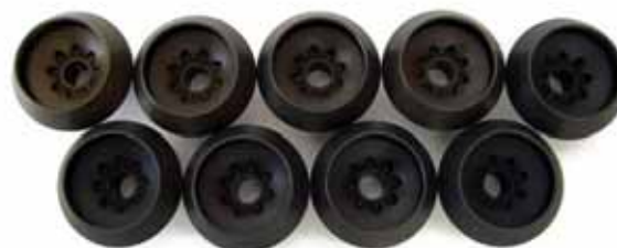
Obr. 5. Zkušební vzorky z materiálu AlCu2SiMn po tvrdé anodické oxidaci.
