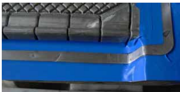
Obr. 3.1 Maskování okolí dělicí roviny formy proti nežádoucímu pokovení
