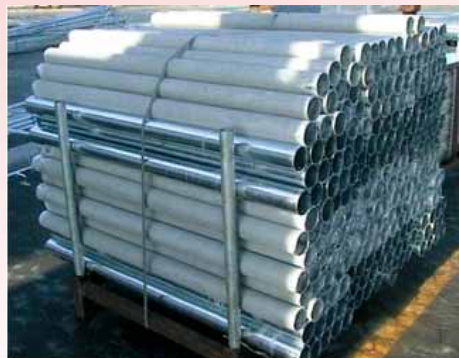
Obr. 5 – Žárově zinkované roury s různým obsahem křemíku. Některé jsou vyrobeny z oceli uklidněné hliníkem a získaly kovově lesklý povrch, zatímco jiné byly vyrobeny z oceli uklidněné křemíkem a získaly
