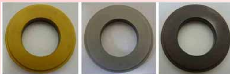
Obr. 2: vzorek s povlakem TiN (vlevo), CrN (uprostřed) a TiAlN (vpravo)
