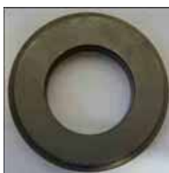
Obr. 1: vzorek po kalení, popouštění a plazmové nitridaci
