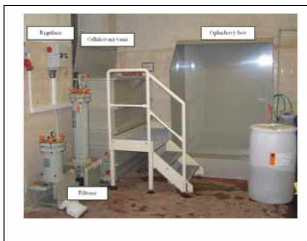
Obr. 5. : Pracoviště pro odlakovací lázeň Master Remover 4500 firmy Galvos spol. s r.o, Hlinsko
