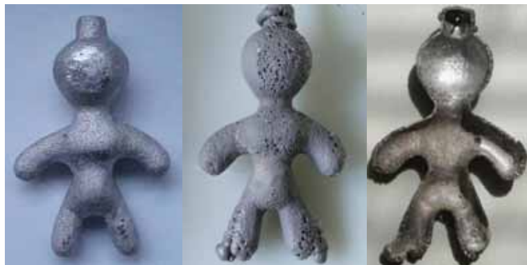
Obr. 3. Vlevo – model z Woodova kovu. Uprostřed a vpravo – galvano vcelku a v průřezu
