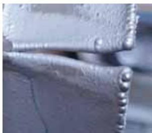
Obr. 2. Praktinagalvanoplastické formy způsobená vnitřním pnutím
