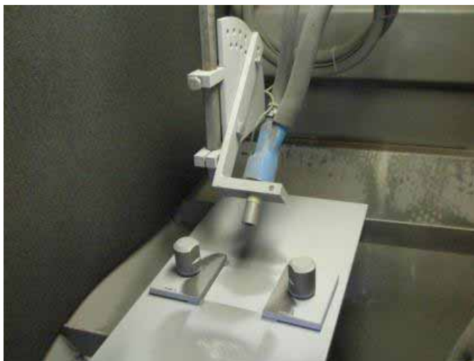
Obr. 1 Pohled z čela na držák trysky druhého typu (nahore) a přídržovač vzorků
