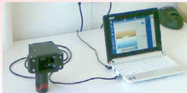
Obr. 1 – Recognoil – přístroj pro optoelektronickou detekci znečištění povrchu – zejména mastnoty
