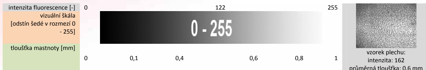
Obr. 2 – Výsledek kalibrace přístroje optoelektronické metody zamaštění
