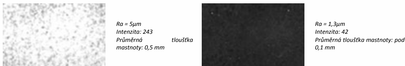
Obr. 4 – Porovnání velikosti zamaštění stejnou koncentrací mastnoty na vzorcích plechu s odlišnou drsností – měřeno zařízením Recognoil (Techtest, s.r.o.)
