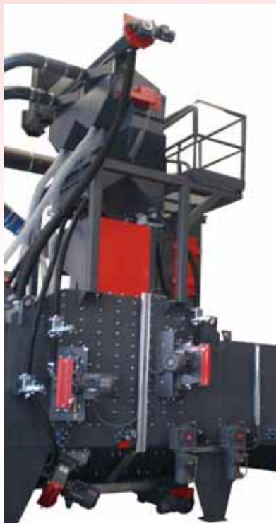
Obr. 3: Instalace osmi turbín zaručuje optimální očištění všech svarů i u dílů se složitou geometrií os.
