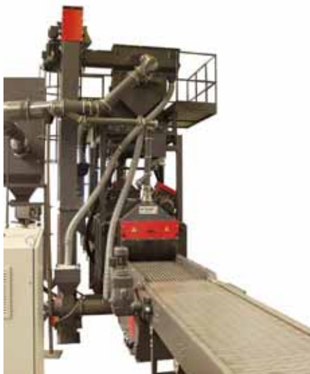
Obr. 1: Po řezání plamenem respektive laserem jsou díly otryskávány v tryskacím zařízení s drátěným pásem.
