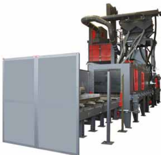
Obr. 2: V zařízení pro otryskávání konstrukcí jsou opracovávány osy o hmotnosti až 1,6 tuny.
