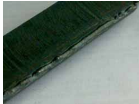
Detaily postižení hrany pálených řezů u kyslíkem řezaných vzorků
