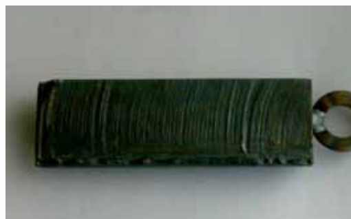
Vzorek 12010 – detail plochy řezu kyslíkem
