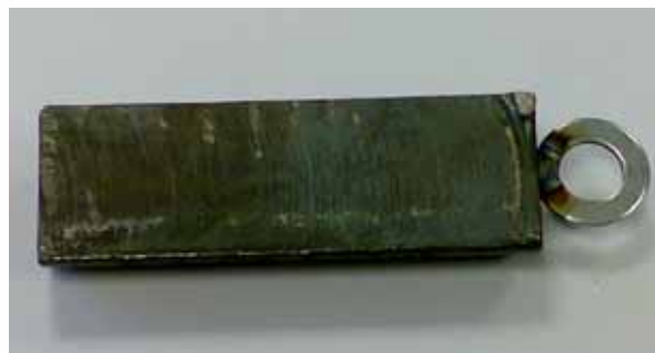
Vzorek 12010 1/2 tyče Ø40 – 100 mm
