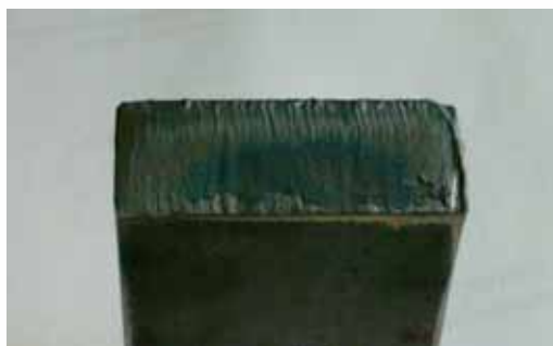
Vzorek 11373 – detail plochy řezu kyslíkem
