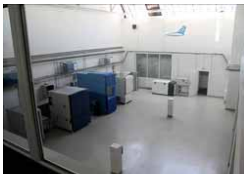
Zkušební haly se zařízením pro provádění klimatických a korozních zkoušek
