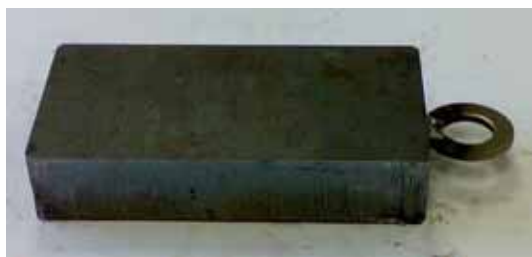
Vzorek 11373 o rozměrech 50x100x20 mm
