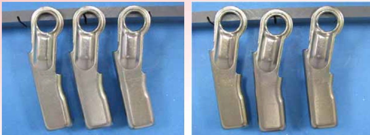
Obr. 9 a 10: Korozní odolnost po 480 h v neutrální solné mlze (dle ISO 9227) bezkobaltové pasivace na bezkvanidovém alkalickém Zn s organicko anorganickým utěsněním před (vlevo) a po (vpravo) tepelném namáhání 24 hod při 120°C.
