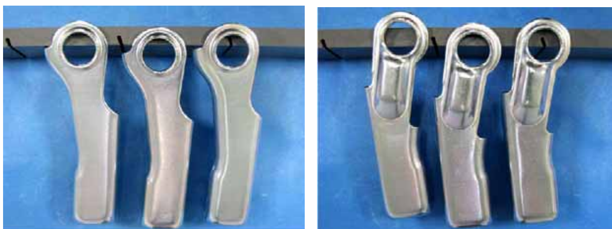
Obr. 7 a 8: Korozní odolnost po 144 h v neutrální solné mlze (dle ISO 9227) bezkobaltové pasivace na bezkyanidovém alkalickém Zn před (vlevo) a po (vpravo) tepelném namáhání 24 hod při 120°C.
