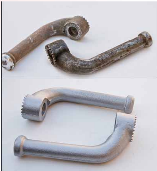
Stupačky motocyklu ČZ Trial byly doplněny dovařením, zabroušený a otryskány korundovým abrazivem, které sjednotilo povrch
