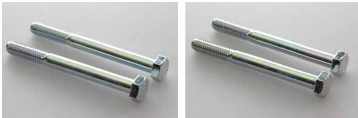
Obr. 5 a 6: Vzhled bezkobaltové pasivace na bezkyanidovém alkalickém Zn před (vlevo) a po (vpravo) tepelném namáhání 24 hod při 120°C.
