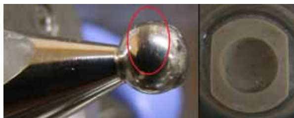
Obr. 7: Referenční hlavice kloubu a jamka po 10 000 testovacích cyklech
