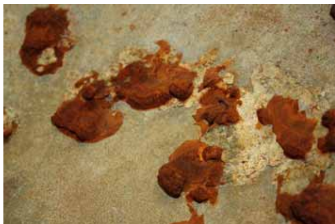
Obr. 4 Korozní produkty bodové koroze tzv. tuberkule
