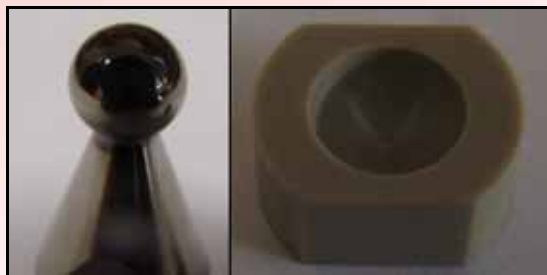
Obr. 8: Hlavice kloubu povrchově modifikovaná metodou IBAD a jamka po 230 000 testovacích cyklech
