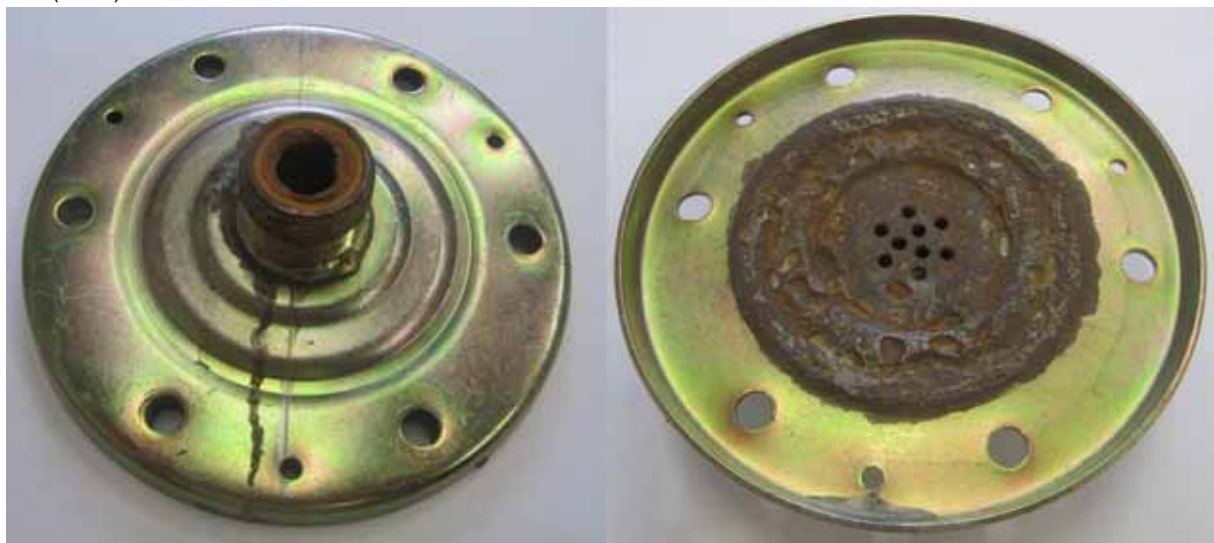
Obr. 1 Porovnání korozního poškození součásti v atmosféře a ve vodě.
