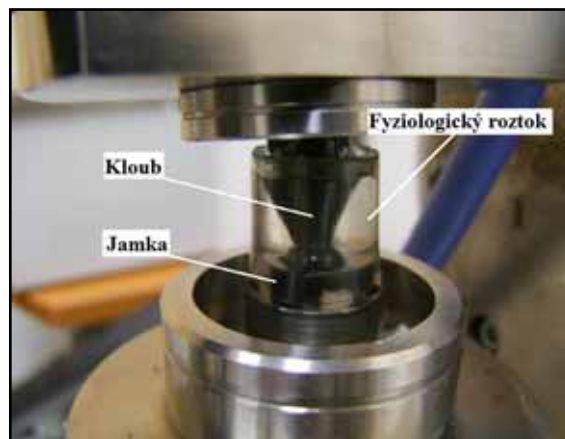
Obr. 6: Průběh tribologického experimentu na simulátoru kloubního opotřebení dvojice kloub - jamka
