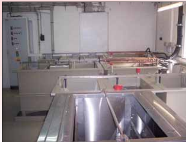
Obr. č. 4: Galvanická linka pro Zn-PTFE povlakování, instalovaná v CVP Galvanika s.r.o. v Příbrami
