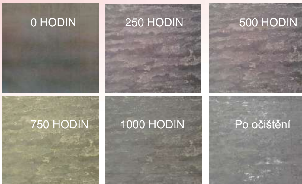
Obr. 8: Fotodokumentace vzorku č.1 v provzdušněné vodě
