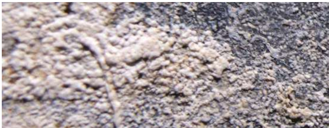
Obrázek č. 2 Přetvarovaný povlak uhličitanu zinečnatého na povrchu zinku
