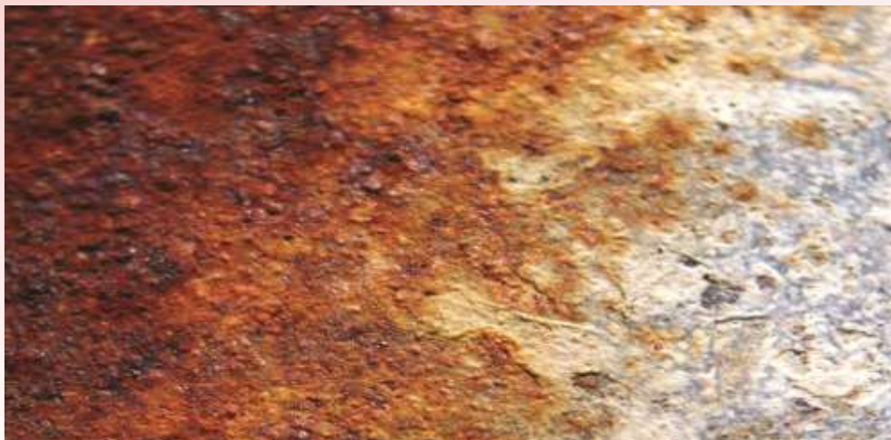
Obrázek č. 12 Souvislá koroze ve vrstvě \gamma (gamma), pronikající až do povrchu oceli
