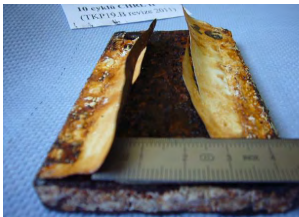
Obrázek 6 – fotografie zkoušených vzorků po 10 cyklech zkoušky CHRL II dle přílohy 19B.P9 (2011). Vlevo systém PKO na oceli s fosfátem a nízkou tloušťkou povlaku, vpravo obdobný systém s vysokou tloušťkou povlaku
