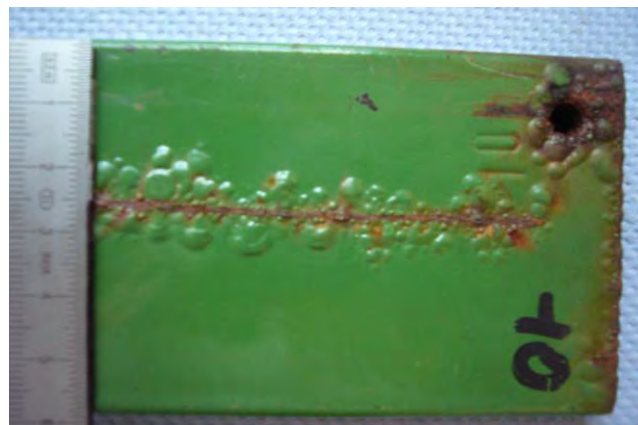
Obrázek 5 – fotografie zkoušených vzorků po 10 cyklech zkoušky CHRL II dle přílohy 19B.P9 (2011). Vlevo vzorek A (systém PKO typu IA), vpravo vzorek B (systém PS s výrazně podkročenou NDFT).
