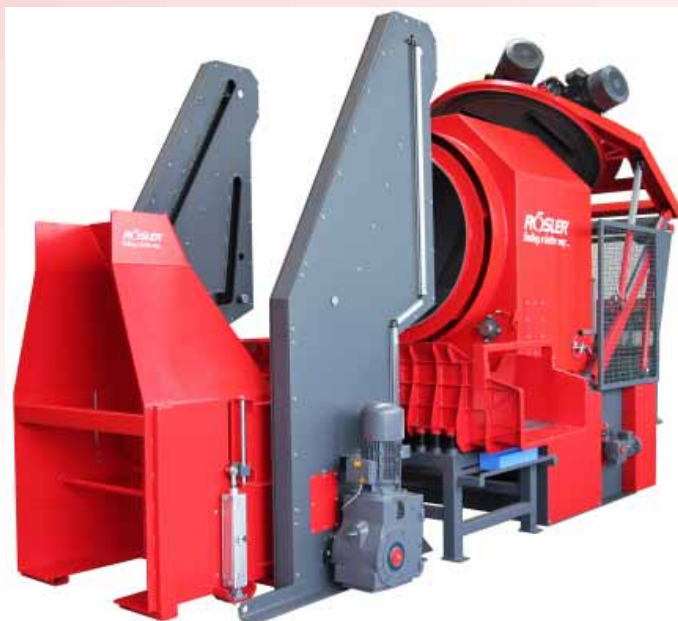
Obr.1: : RMT 100 pro maximální hmotnost dávky 2350 kilogramů. U největšího provedení, RMT 120 HD, lze zpracovávat dávky až 4000 kilogramů.
