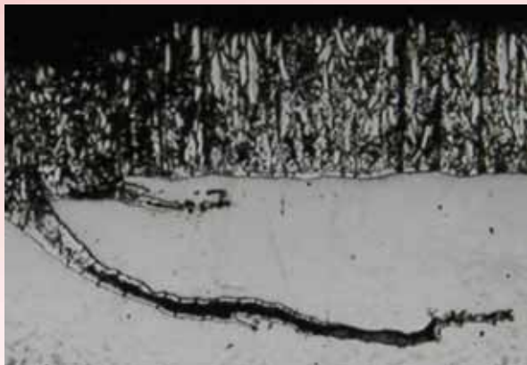
Obr. 3 Přeložka na podkladové oceli
