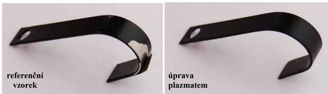
Obr.6: Porovnání zvýšení adheze nanesené barvy BLACK BIG TRUCK k povrchu ocelových pásek (3-vrstvý systém: 1x základní nátěr + 2x finální nátěr), které byly předupraveny plazmatem ve fázi před druhým finálním nátěrem, oproti vzorku bez plazmové úpravy (ohybový test).
