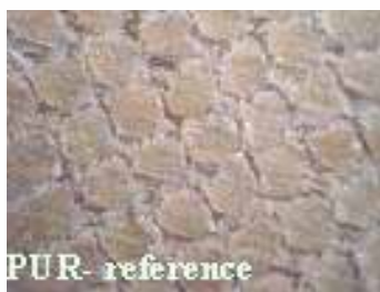
Obr.1: Porovnání zvýšení adheze laků k povrchu dřeva, které bylo před lakováním předúpraveno plazmatem, oproti vzorku bez plazmové úpravy (peel test - ČSN EN 311, cross hatch adhesion test - ČSN EN ISO 2409). [2]
