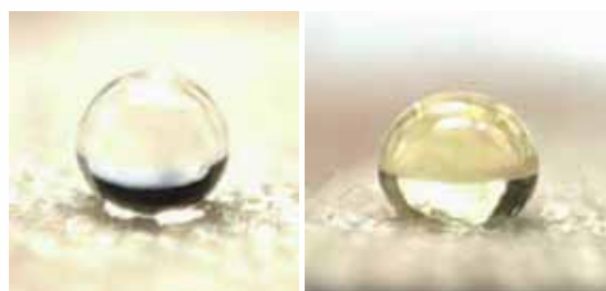
Obr.11: Souběžná ultrahydrofobní (vlevo – kontaktní úhel 161^\circ ) a superolejofobní (vpravo – kontaktní úhel 140^\circ ) povrchová úprava textilu. [5]
