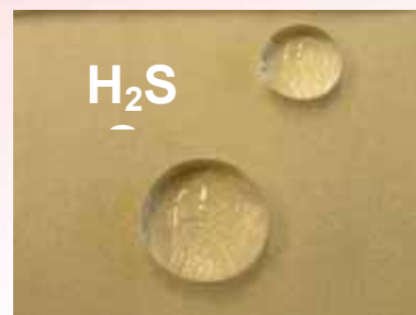
Obr.12: Ultrahydrofobní nanovláknenná vrstva z PA 6 na substrátu z papíru - testování chemické odolnosti nanokompozitu na různé vybrané kyseliny (zvoleným kritériem chemické odolnosti povrchové úpravy pro danou kyselinu byla její maximální koncentrace, kdy ještě zůstává plně zachována ultrahydrofobita povrchu nanokompozitu).
