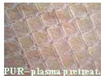
Obr.1: Porovnání zvýšení adheze laků k povrchu dřeva, které bylo před lakováním předúpraveno plazmatem, oproti vzorku bez plazmové úpravy (peel test - ČSN EN 311, cross hatch adhesion test - ČSN EN ISO 2409). [2]
