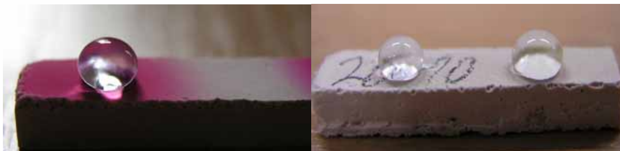
Obr.9: Ultrahydrofobní povrch geopolymérů s pigmenty (vlevo) a v původní barvě (vpravo).
