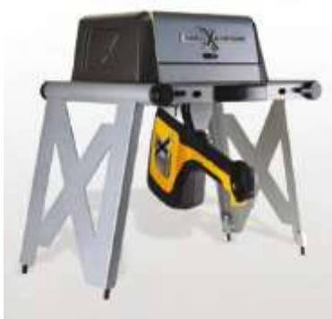
Obr. 7 Umístění spektrometru DELTA ve stativu pro měření galvanických lázní (vlevo), Ramanův spektrometr (vpravo)
