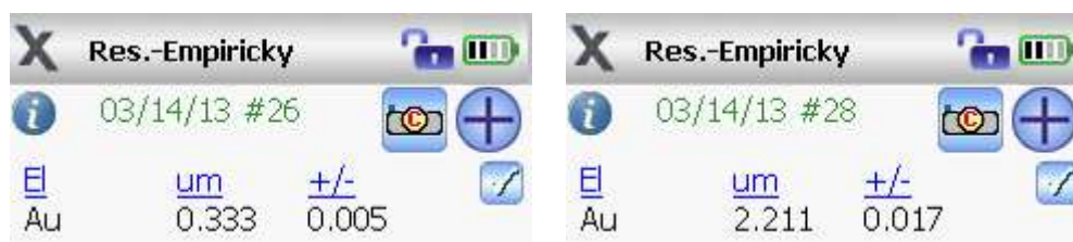
Obr. 5 a 6 Příklad sejmuté obrazovky se zjištěnou tloušťkou povlaku
