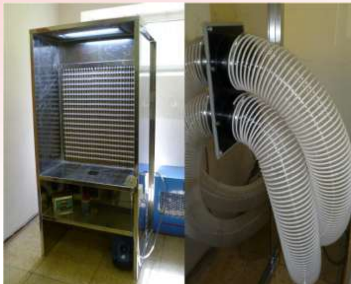
Obr. 2 Laboratoř nátěrových systémů s kabinou pro aplikaci nátěrových hmot s obsahem nanočástic.
