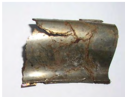
Obr. 7 Korozní napadení kompenzátoru z oceli Cr18Ni10 ve spalinách pod rosným bodem HCl
