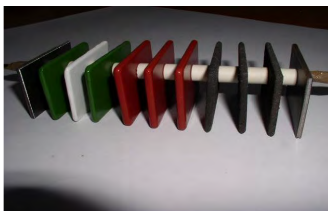
Obr. 10 Vzorky umístěné v tkaninovém filtru spalovna Bratislava
