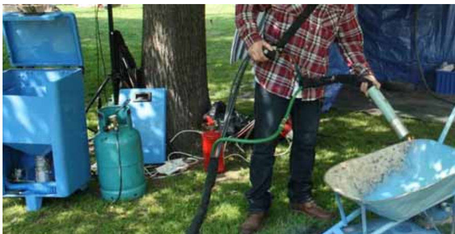
Obr. 1: Nové technologie pro nanášení práškových plastů při žárovém nástřiku v exteriéru
