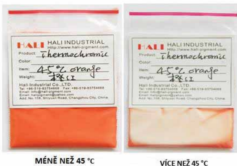
Obr. 5 Termochromický pigment před a po zahřátí [7]
