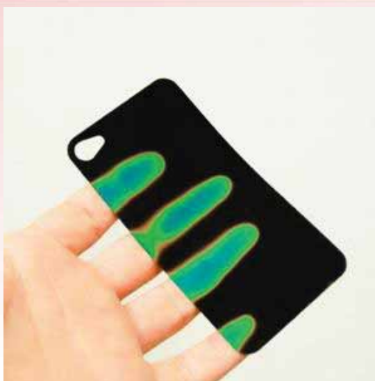
Obr. 4 Kryt na mobilní telefon – technologie tekutých krystalů [6]
