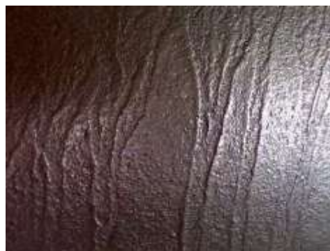
Obr. 3: Povlak postižený stečeninami
