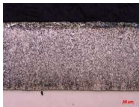
Obr. 4: Řez povlakem na oceli s obsahem Si 0,08 %
