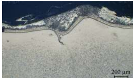
Obr. 14: Povrchová nečistost substrátu
