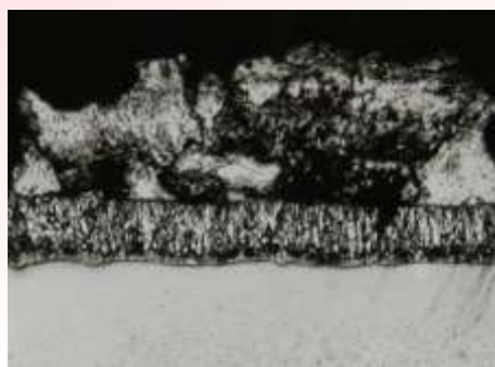
Obr. 6: Řez naplavenou hrudkou
