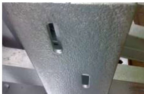
Obr. 17: Povlak na hrubém podkladu
