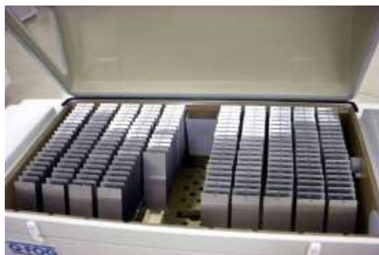
Obr. 3: korozní panely v komoře Q-FOG CCT 600
