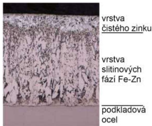
Obr. 2: Povlak na oceli uklidněné křemíkem
