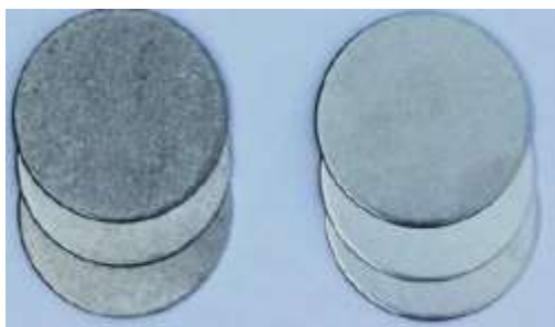
Obr. 2 Vzorky ze slitiny hliníku před a po procesu omílání
