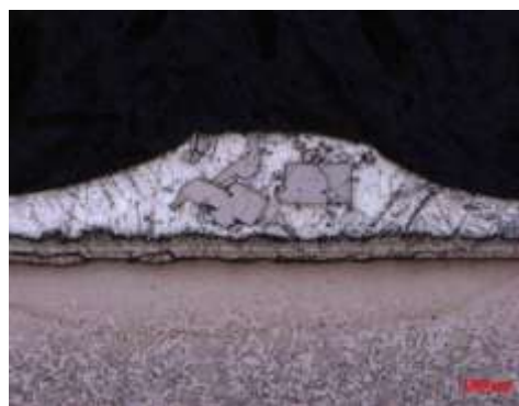
Obr. 8: Krystaly tvrdého zinku zalité v povlaku
