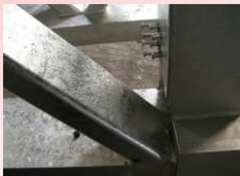
Obr. 5: Naplavené hrudky tvrdého zinku
