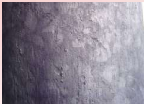
Obr. 11: Povlak na trubce tvářené za tepla
