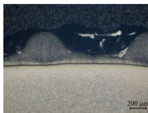
Obr. 10: Metalografie směsné struktury
