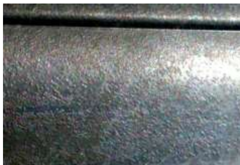
Obr. 15: Směsné struktury doprovázené puchýřovitostí
