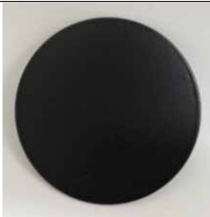
Obr. 2 – Povlak LV EPS 620 S2 – pneumaticky stříkáno
