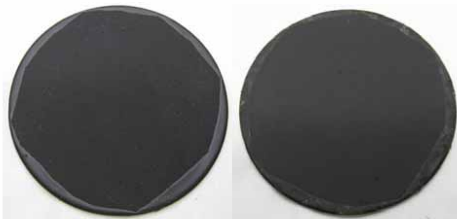
Obr. 3 – Povlak LV EPS 620 S2 – před (vlevo) a po (vpravo) korozní zkoušce oxidem siřičitým s povšechnou kondenzací vlhkosti, doba expozice 240 hod
