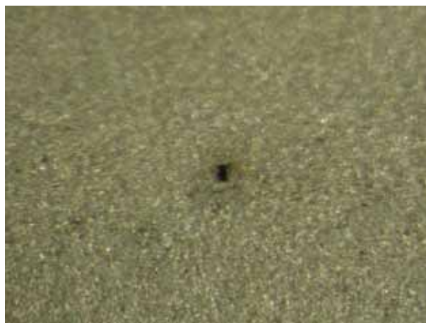
Obr. 1. Povrch elektrody a detail důlku po expozici 0.5 \text{ mol.dm}^{-3} \text{ H}_2\text{SO}_4 + 0.5 \text{ mol.dm}^{-3} \text{ Cl}^-
