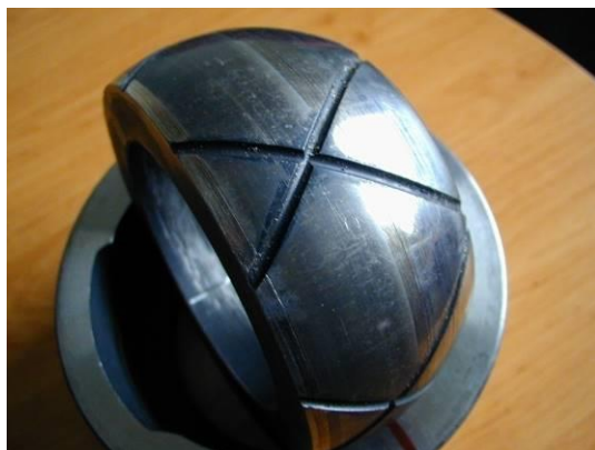
Obr. 3 Vnitřní a vnější kroužek ložiska PLC 89-8 po provozu 10 000 hod. v uložení převodovky na rotační peci [2]
