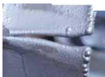
Obr. 5 Prasklina galvanoplastické formy způsobená vnitřním napětím [3]
