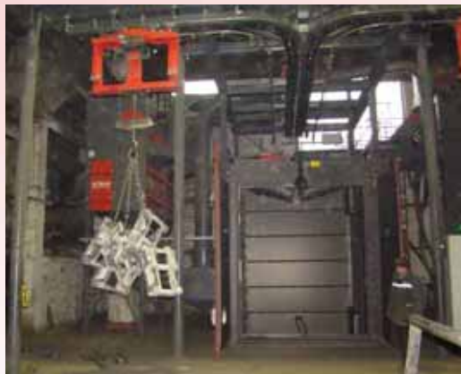
Obr. 2: Bildunterschrift: Odlitky pump jsou tryskány jednotlivě nebo v dávkách. Maximální rozměry dílů činí 2,5 x 3,0 m (Š x V), nosnost závěsu je 5 tun.
