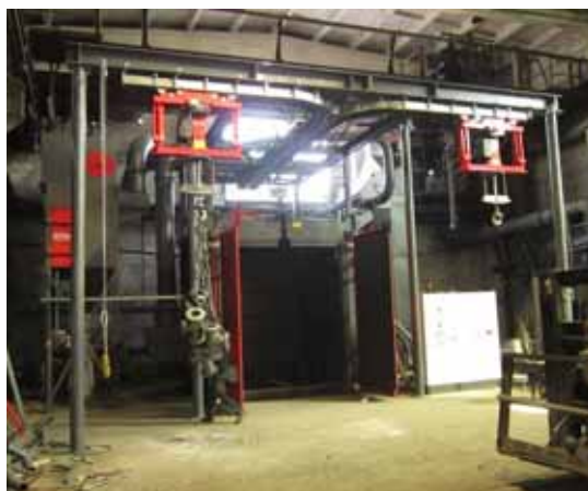
Obr. 1: Die RHBE 27/32-F bylo konstruováno pro zvláštní požadavky pro odstraňování jader. Součástí zařízení je také příprava tryskacího média s dvojitým magnetickým separátorem a speciálními patronami vybaveným filtračním systémem.
