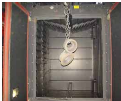
Obr. 2: Popis obrázku: Optimalizovaná ochrana proti opotřebování se sestává z tryskací komory zhotovené z 10 mm silné manganové oceli a v tryskacím prostoru s vyměnitelnými 25 mm silnými deskami z otěruvzdorné oceli a na boční straně se umístěnými 10 mm silnými deskami z manganové oceli.
