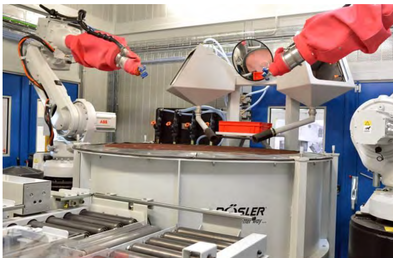
Obr. 1.: Nová technologie Surf-Finishing umožňuje cílené individuální opracování obrobků s povrchem náchylným k poškození ve velmi krátkých cyklech.
