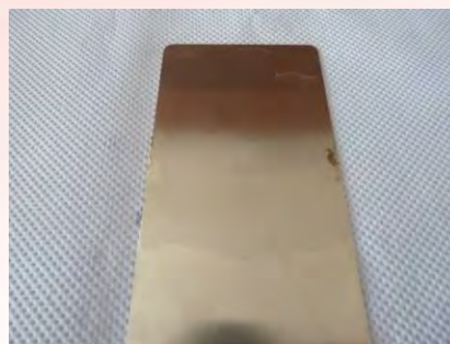
Vzorek oceli po aplikaci plazmatu
