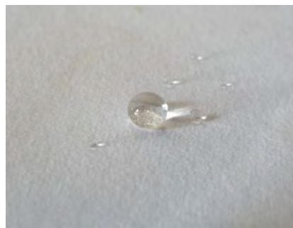
Úprava papíru nanosklem
