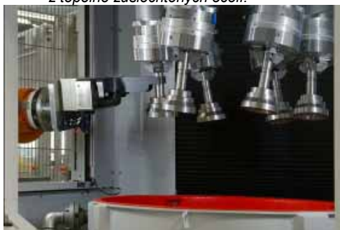
Obr. 2: Oba schleppfinishery systému jsou vybaveny vždy šesti pracovními vřeteny. Pro polohově přesnou robotickou manipulaci byl vyvinut koncept spolehlivého obsazování.
