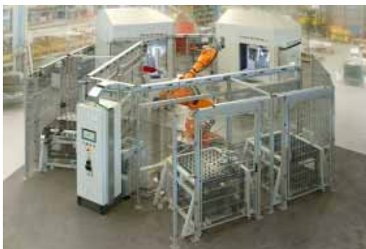
Obr. 1: Inovativní systém Schleppfinishing R6/1000 SF-Auto s robotickým podáváním umožňuje plně automatizované odhrotování těl nástrojů z tepelně zušlechtěných ocelí.
