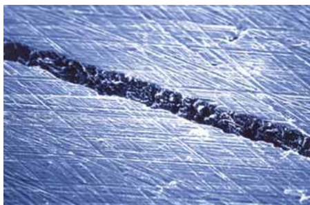
Obr. 4: Struktura povrchu válce se stopou bez valu, vytvořenou laserovým honováním [9]
