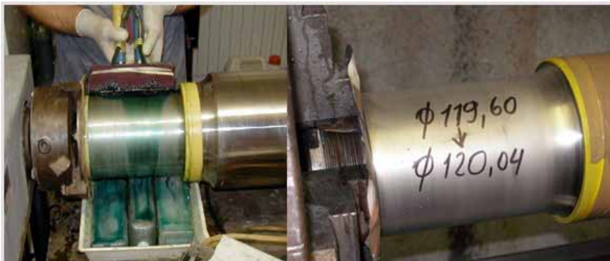
Obr. 2: Renovace vnějšího průměru hřídele pomocí technologie tampónování. Vlevo hřídel při renovování pomocí technologie tampónování, vpravo hřídel po renovování pomocí technologie tampónování. [5]
