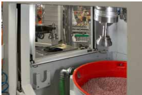
Obr. 3: Na obrobku ulpívající brusná tělíska jsou po procesu odstraňována ve vodní čisticí stanici směsí vody, kompoundu a vzduchu.
