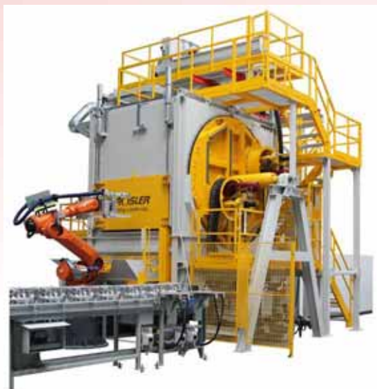
Obr. 1.: Tryskací zařízení ve tvaru bubnu pro bloky motorů obsahuje dvě trykací komory. Tímto lze během trykacího procesu zavážet a vyvážet díly.
