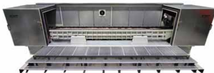
Obr. 1: Trog_Aluteile – Vibrační zařízení s pracovní nádobou o rozměrech 425 x 7400 mm pro obrábění hliníkových konstrukčních dílů má výkonný TUD pohon, jehož motor rovnoměrně rozděluje pohyb po celé délce pracovní nádoby.
