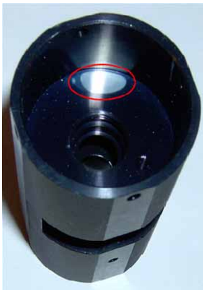
Obr. 2: Bublina - Nesprávné uchycení součásti v lázni, které má za následek zachycení bubliny stoupajícího kyslíku a vznik místa bez eloxované vrstvy.
