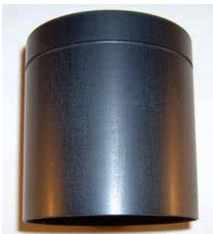
Obr. 1: Přemožený výrobek - Dlouhá doba moření vyleptala (odkryla strukturální nehomogenitu materiálu). Intenzita (hloubka vyleptání) je dána jednak složením hliníkové slitiny, ale i způsobem zpracování slitiny = tažení, válcování apod.
