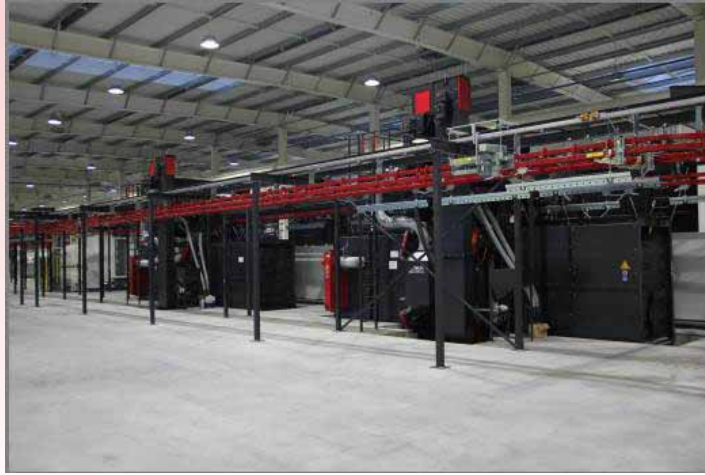
Obr. 2: Díly procházejí dvěma identickými závěsnými tryskacími zařízeními pro odstranění okujů a dalších nečistot a na závěr se Shot Peeningem
