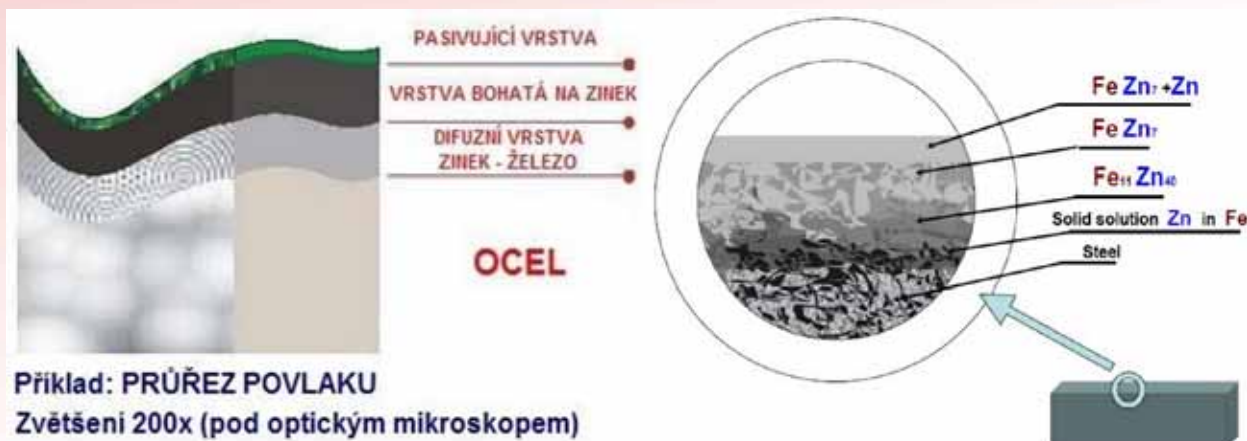
Obr. 1: Jednotlivé vrstvy difuzního zinku při difuzním zinkování [4]
