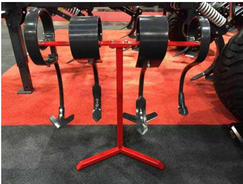
Obr. 1: Vibrační radlice jsou vystaveny vysokému zatížení během úpravy půdy. Shot Peeningem se zvýší jejich životnost dvojnásobně
