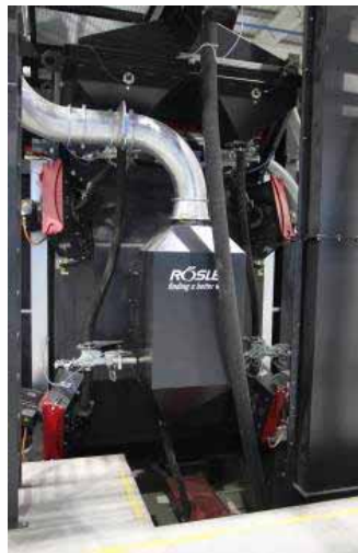
Obr. 3: Každé zařízení je vybaveno osmi metacími koly typu Gamma® 400G. Toto umístění umožňuje, že jsou všechny typy radlic zcela otryskány, aniž by se tryskací obrazy potkaly
