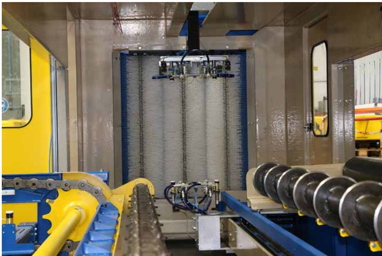
Obr. 3: Čistění s kartáči redukuje zatížení jemného filtračního systému až o 60 do 80 procent.
