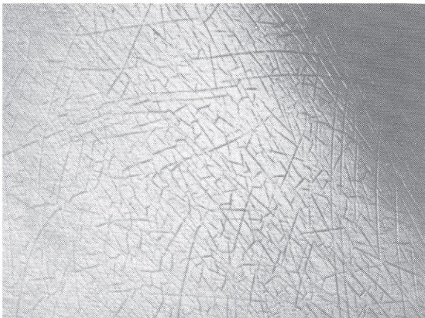
Obr. 1: Druh prasklinek forma trhlin charakterizovaná jemnými prasklinami rozmístěnými po povrchu suchého filmu ve více nebo méně pravidelném vzoru
