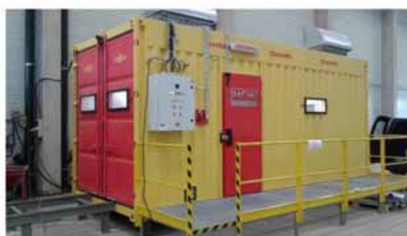
Pracoviště povrchových úprav (tryskání, broušení a žárové nástřiky) typ kontejner 6x2,4x3m
