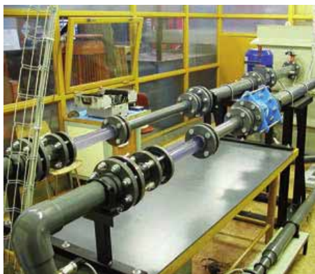
Obr. 1: Ukázka výroby prášků pomocí hydrokavitace,
