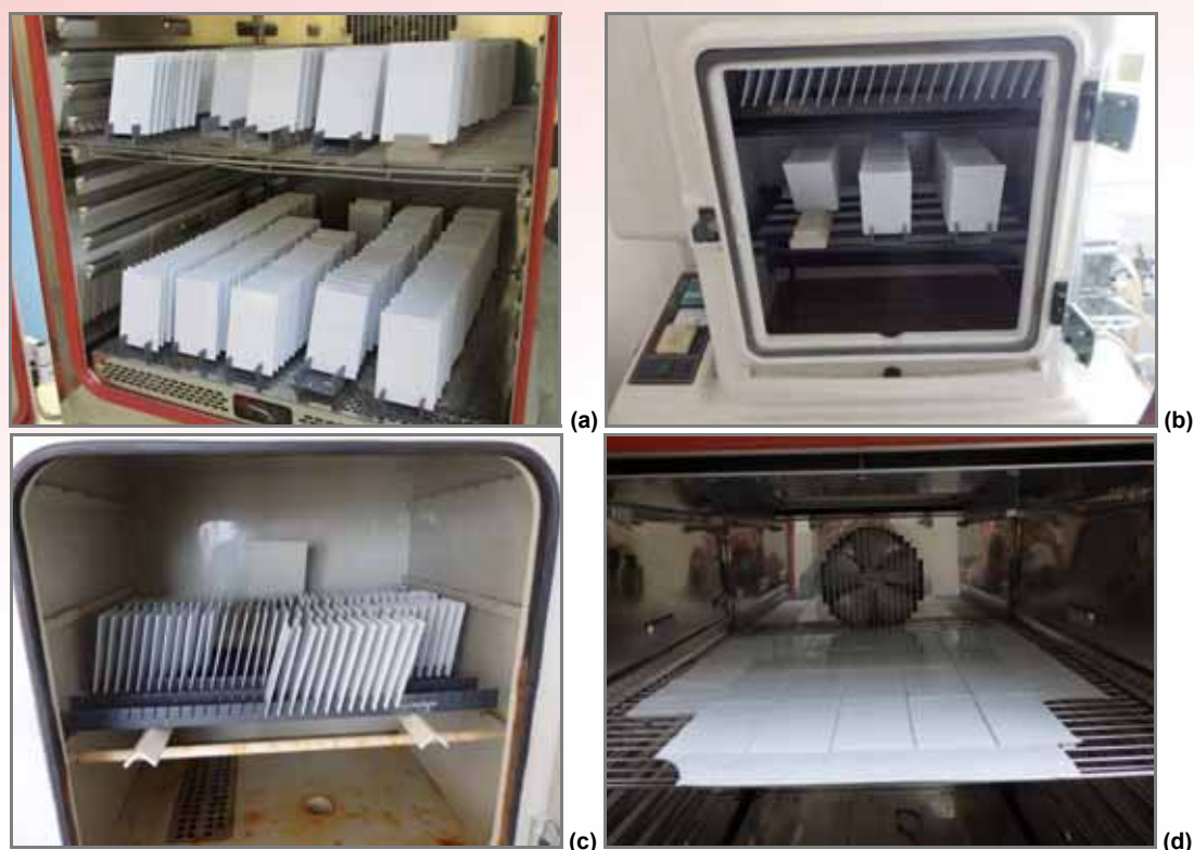
Obr. 1: Umístění vzorků ve zkušebním zařízení, (a) vlhké teplo cyklické, (b) SO 2 , (c) solná mlha a (d) sluneční záření
