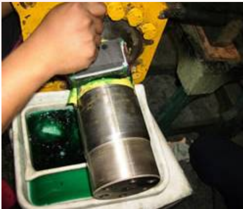
Obr. 3: Renovace nápravy kamionu niklem za pomoci tampónové technologie. [3]
