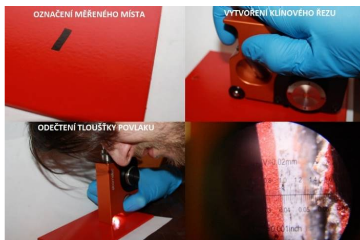
Obr. 3: Postup stanovení tloušťky jednotlivých vrstev nátěrového systému klínovým řezem
