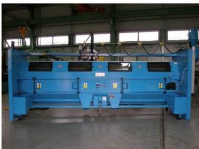
Pneumatické tryskové zařízení automatické s manipulátorem, typ PTZ – ATR
