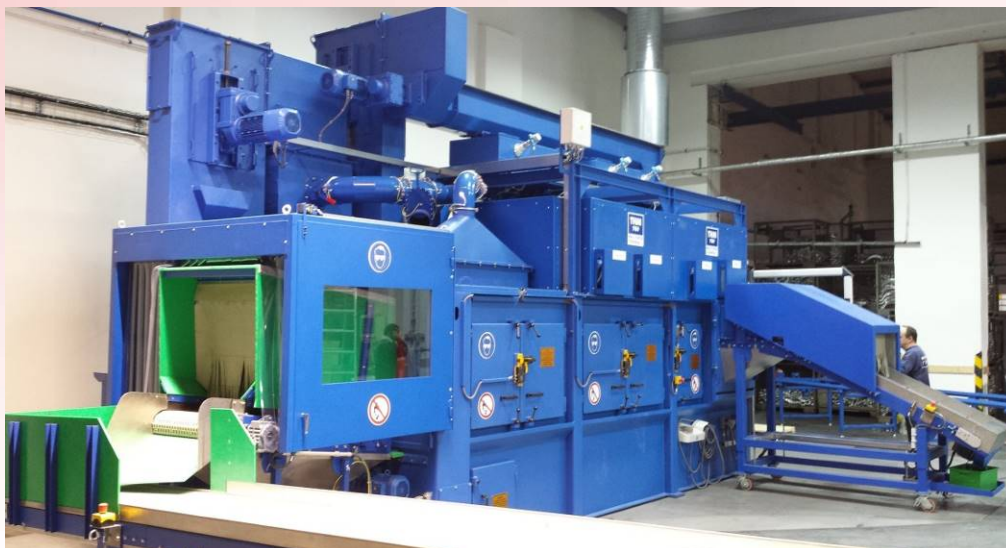
Obr. 4: Průběžné tryskací zařízení THM 700/4/E pro tryskání hliníkových výkovek
