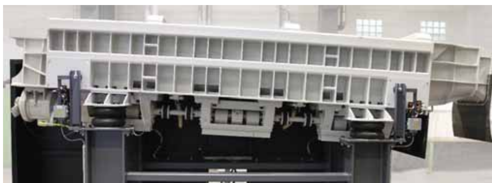
Obr. 3: Aby nedošlo při separaci k poškození odlitek citlivých na náraz, je separační stanice dvoustupňová s minimální výškou pádu. Integrované oddělování podsítného je vybaveno plynule nastavitelným tyčovým sítím.
