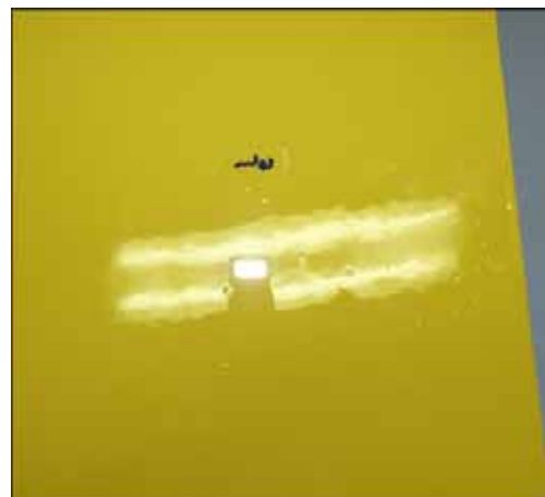
Povrch gelcoatu pečlivě očištěný isopropanolem
