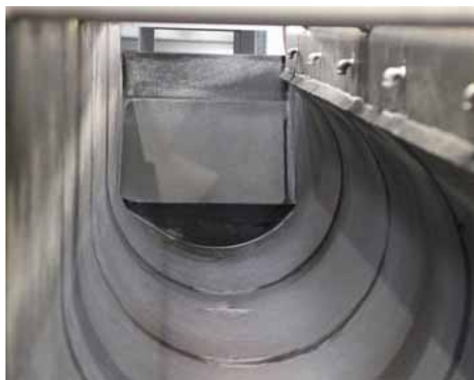
Obr. 2: Speciální konstrukce pracovní nádrže s jednostranným zaoblením ve tvaru U podporuje optimální pohyb brusných tělísek a obrobků.
