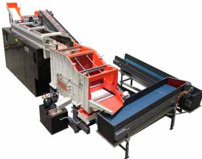
Obr. 1: Systémem R 550/4600 DA se obrábí asi 30 různých odlitek s maximálním průměrem 300 mm.
